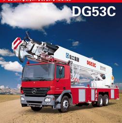
德国奔驰Actros3332底盘;5节伸缩臂+1节 折叠臂结构;工作平台最大负载400kg,工作 平台上预留救生通道,可通过多种渠道实施 救援;整机具有半边作业工况;电淀比例控制技术,整机22项安全保护装置。历经多年 灭火救援实战,具有良好的客户口碑。
