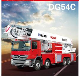
奔驰Actros4144或曼41.440底盘; 2.5吨(水)+0.45吨(A类泡沫液)的消防液罐,美国大力公司PSP1500型水泵,自动压缩空气泡沫系统(CAFS统),阿重0.4吨,基本臂吊重2吨,引领7956最新标准的新一代登高消防车。
