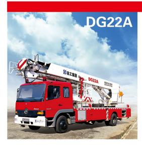
德国奔驰Atego1523底盘; 2节伸缩臂+1节折叠 管结构,结构合理,强度储备系数大;工作平台最大负载320kg;电液比例控制技术,车辆救援效率高,操作方便;整机11项安全保护装 置。是国内同级别最为可靠的消防车。
