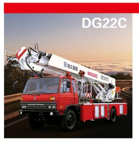
东风底盘; 2节伸缩臂+1节折叠臂结构, 结 构合理,强度储备系数大;工作平台最大负 载300kg; 电液比例控制技术, 车辆救援效
